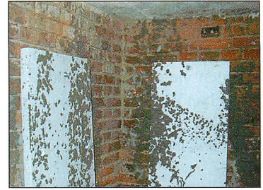
Abb. 5. Styroportafeln mit Putzbewurf, wandseitig befestigt.
