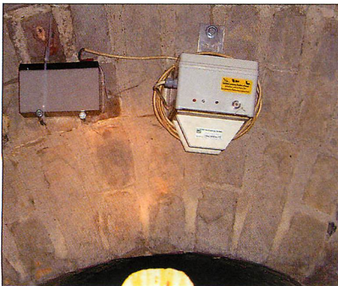
Abb. 1. Eingebautes und aufnahmebereites Fledermaus-Aktivimeter (FAM). Aufn.: G. PRESCHEL.
