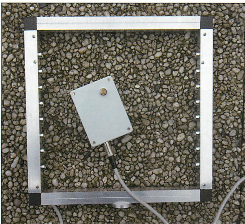
Abb. 2. Lichtschrankenvorhang fest: Fester Rahmen zum selbsttätigen Aufbau eines Flugtunnels mit eigenen, individuell angepassten Maßen.
