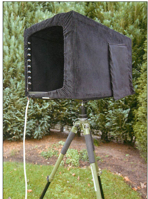
Abb. 1. Flugtunnel: Die acht Sende- und Empfangssensoren bilden den Lichtschrankenvorhang im Flugtunnel. Alle Aufn.: DIETER MAHLKE.
