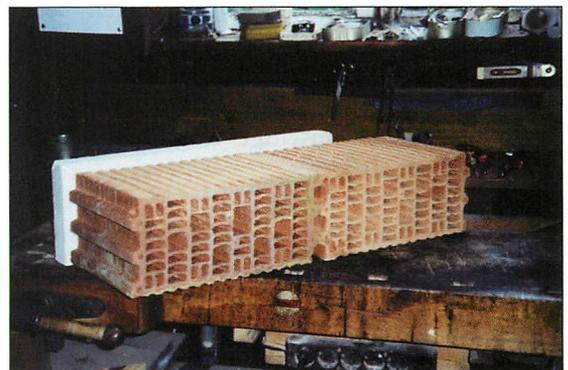
Abb. 34. Zwei Porotonbetten des gleichen Typs aneinandergereiht.
