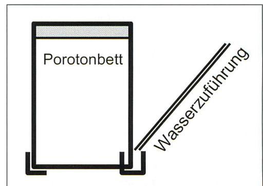
Abb. 40. Prinzip der Feuchteversorgung von Porotonbetten über Regenfangbecken.
