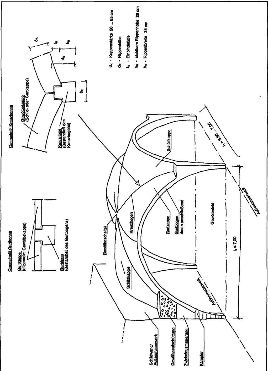
Abb.3. Statische Begriffe und Abmessungen der Kellergewölbe in der Hardenburg
