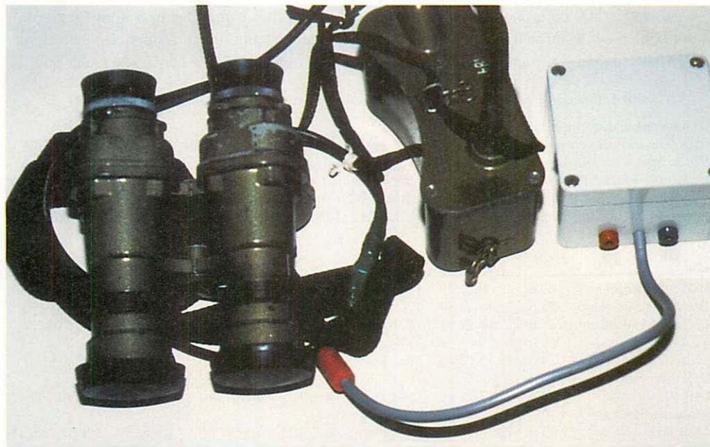
Abb. 2. Nachtsichtgerät russischer Bauart mit Restlichtverstärker
