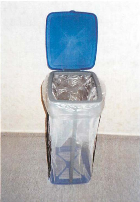
Abb. 4. Zum Fledermausbehälter umgebauter Müllsackständer: Umkleidung mit Fliegengaze; innen herabhängend: Müllsack aus dünner durchsichtiger Plastikfolie; Höhe 72, Breite 29, Tiefe 30 cm. Aufn.: MARCEL GLOBIG
