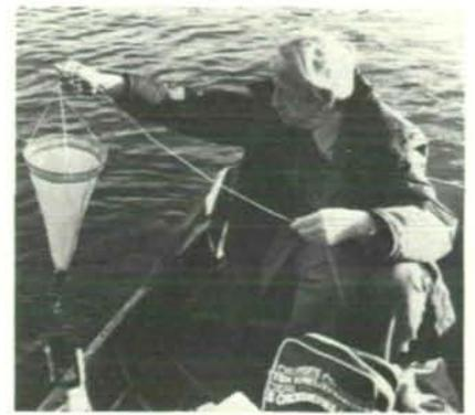
Der Verfasser beim Planktonfang am Wolfgangsee. Das Planktonnetz wird aus dem Wasser gezogen. Die Planktonbewohner sind in dem am unteren Ende des Netzes befindlichen Sammelgefäß gefangen.
