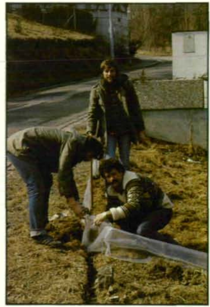
Abb. 5: G. Laister, H. Rubenser und F. Schwarz beim Spannen der Plastikfolie. Diese wird von u-förmig gebogenen Eisenstäben gehalten und durch eine Drehung um 270° gespannt.
