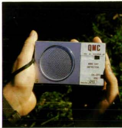
Abb. 4: Der Fledermausdetektor ist ein Gerät, mit dem die von den Fledermäusen ausgestoßenen Ultraschallrufe für den Menschen hörbar gemacht werden. Eine genaue Differenzierung der 24 Fledermausarten anhand ihrer Rufe ist mit diesem Gerät allerdings nur begrenzt möglich.
