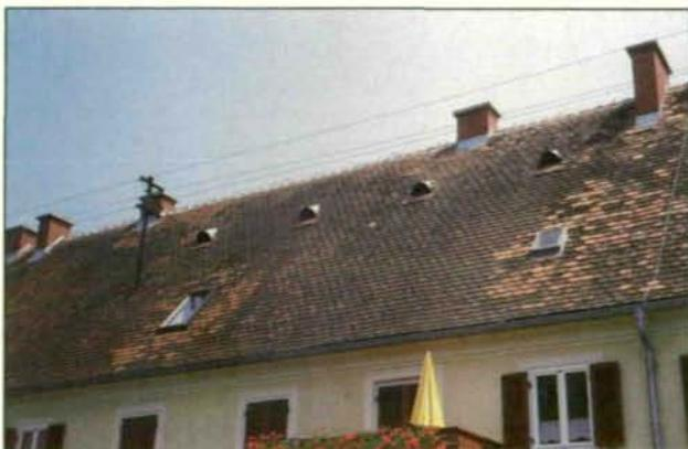
Abb. 6: Als geeignete Einflugöffnungen in Dachböden eignen sich Lüftersteine, bei denen das Sieb entfernt wurde. Stadttäuben können durch die Öffnungen nicht in die Dachböden gelangen. \* Foto: A. Baar
