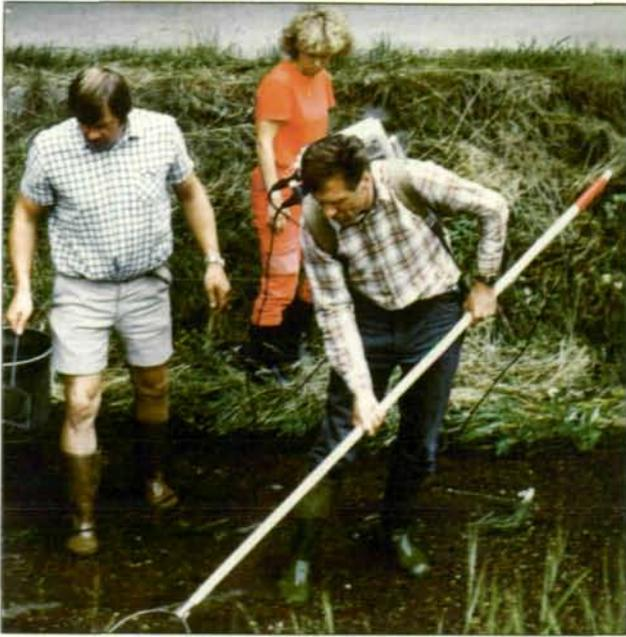
Abb. 26: Die kleineren Gerinne wurden mit einem tragbaren Gleichstromaggregat befishet. Foto: NaSt-Archiv
