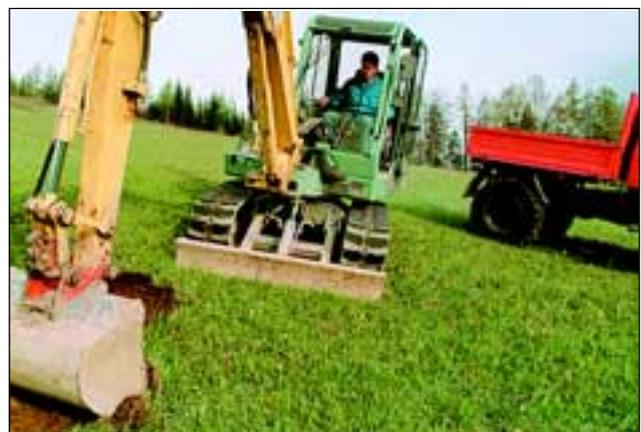
Abb. 16: Vorsichtiges Abtragen des Kalkmagerrasens in ca. 60 x 80 cm großen, 10-15 cm dicken Wiesenstücken, mit dem Kleinbagger und Verladen auf den Unimog, welcher an diesem Tag 35 Fuhren zur Ersatzfläche brachte.
