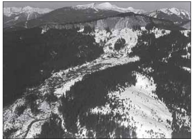
Abb. 19: Felsstürze von der Zwerchwand bei Goisern 1978 und 1980, die 1982 einen größeren Erdstrom mit anschließender Mure zur Folge hatten. Foto: Sordian
