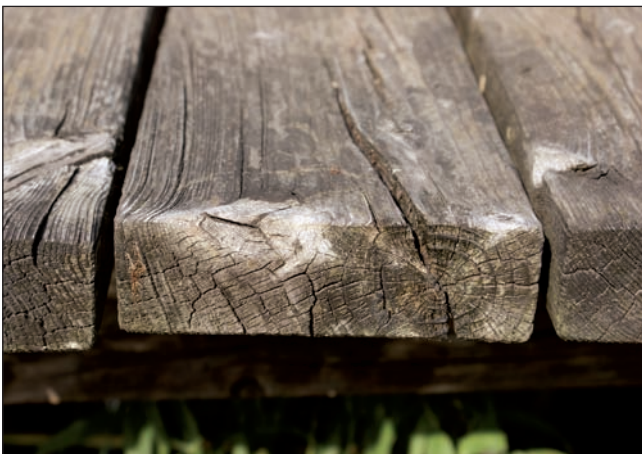
Abb. 7: Kernholz neigt zum Verwinden und zur Rißbildung. Foto: M. Kumpfmüller
