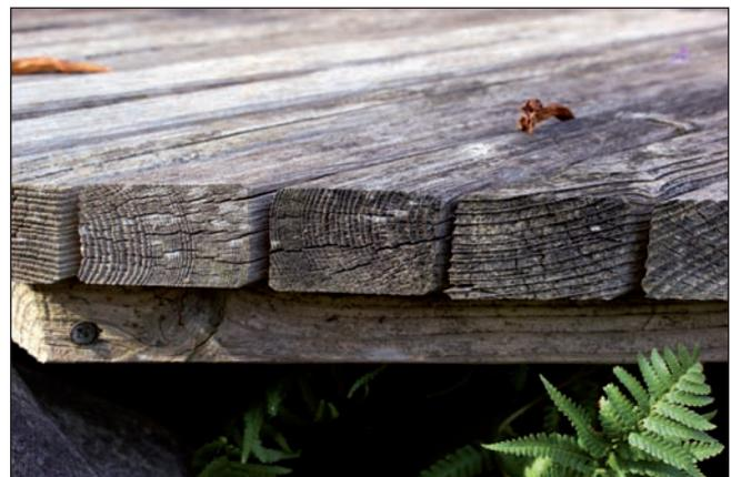
Abb. 8: Die beiden linken Kanthölzer sind auf Rift geschnitten - stehende Jahrringe. Rechts Fladerschnitt.
