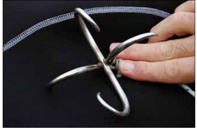
Abb. 50: Ein speziell für das Fischen von Wasserpflanzen angefertigter vierfacher Haken, der an eine Schnur geknüpft wird. Durch die verdrehte Richtung der Hakenschenkel verhängt sich dieser nicht beim Einziehen der Schnur.
