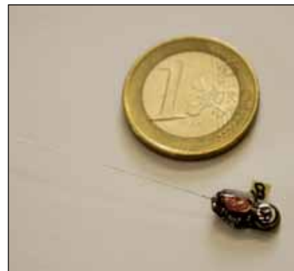
Abb. 4: Radiotelemetrie-Sender der Firma Holohil (Modell LB-2N) mit einem Gewicht von 0,42 g – entwickelt für die Untersuchung von Fledermäusen. Foto: G. Reiter
