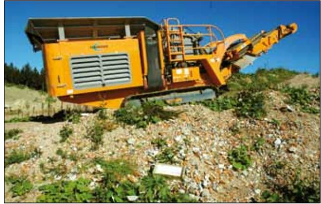
Abb. 7: Von Huflattichblättern umzingelte Brechmaschine zum Zerkleinern des Bauschutts auf der Bauschuttdeponie in Mehrbach/Gigling.
