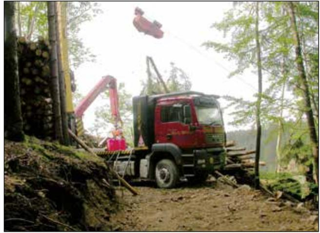
Abb. 7: Die umgeschnittenen Fichten wurden mittels Seilkran nach oben transportiert.
