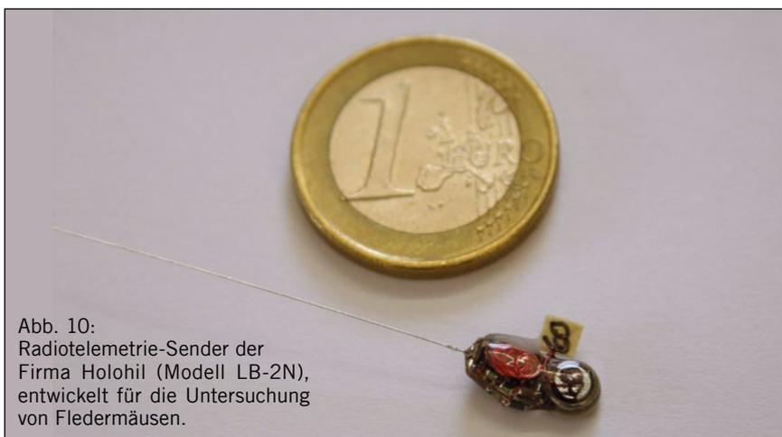
Abb. 10: Radiotelemetrie-Sender der Firma Holohil (Modell LB-2N), entwickelt für die Untersuchung von Fledermäusen.
