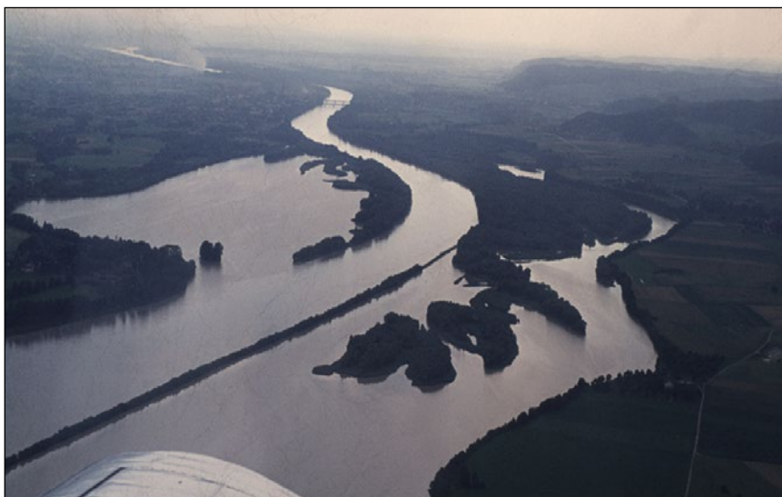
Abb. 4: Bildung neuer Inseln und Buchten im Stauraum Ering-Frauenstein flussabwärts von Braunau. Links die zum Zeitpunkt der Aufnahme 1975 noch vorhandene, nicht mit Inseln erfüllte ‚Hagenauer Bucht‘; rechts die Inseln auf bayerischer Seite. Foto: J. H. Reichholf
