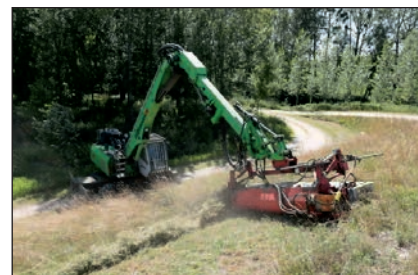
Abb. 23: Da der Damm nicht befahren werden kann, wurde ein Mähgerät entwickelt, das zwei Schritte in einem erledigt.
