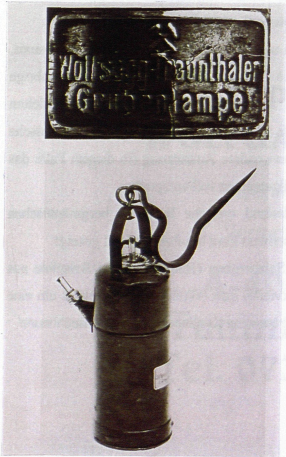
Abb. 3 Azetylen-Handlampe (Karbidlampe) der Wolfsegg-Traunthaler Kohlenwerks AG. (Modell Scharlach, Nürnberg) mit Firmenschild
