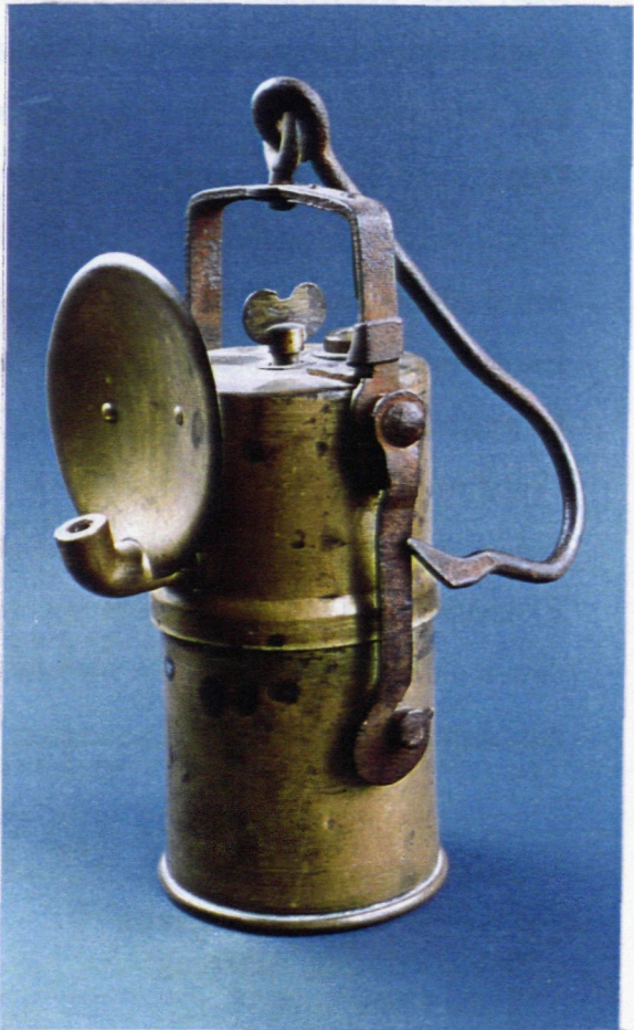
Abb. 4 Azetylen-Handlampe (Karbidlampe) aus Messing aus dem Kaolinbergbau Schwertberg
