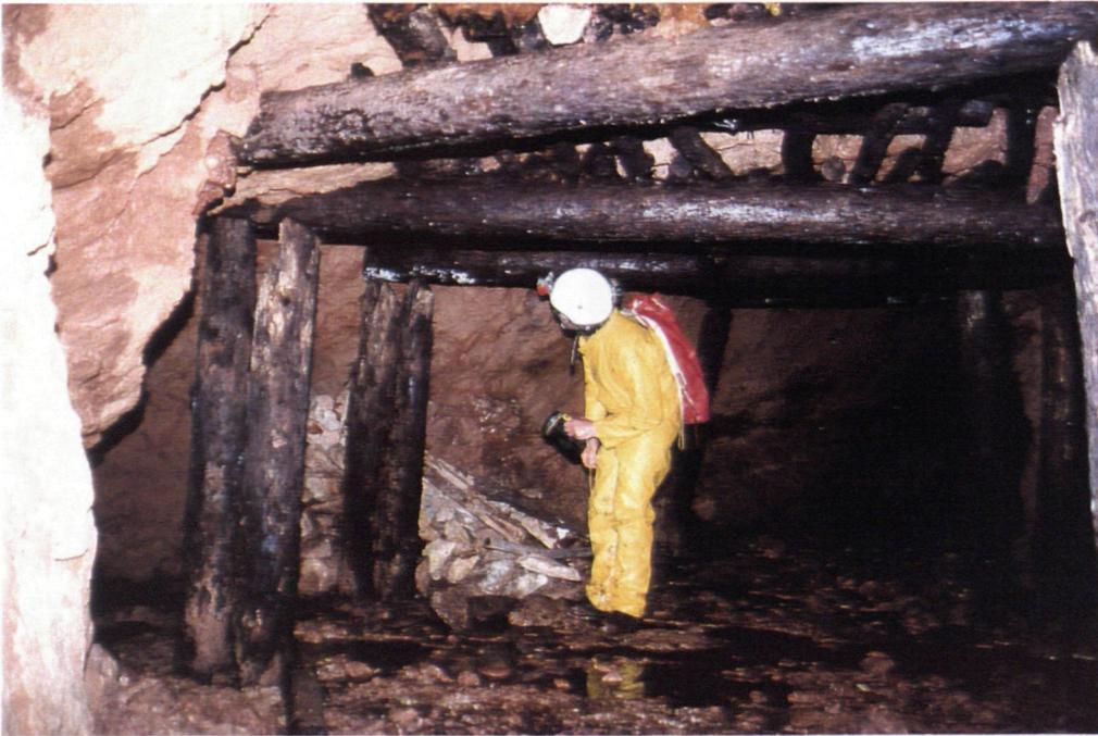
Abb. 12: Abbauhohlraum mit Zimmerung des Bauxitbergbaues Unterlaussa
