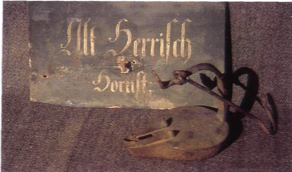
Abb. 3 Froschlampe, „geschlossener Frosch für Ölbrand“ mit alter Stollenmarkierungstafel „Alt Herrisch Horn-Stollen“ aus dem Salzbergbau Hallstatt
