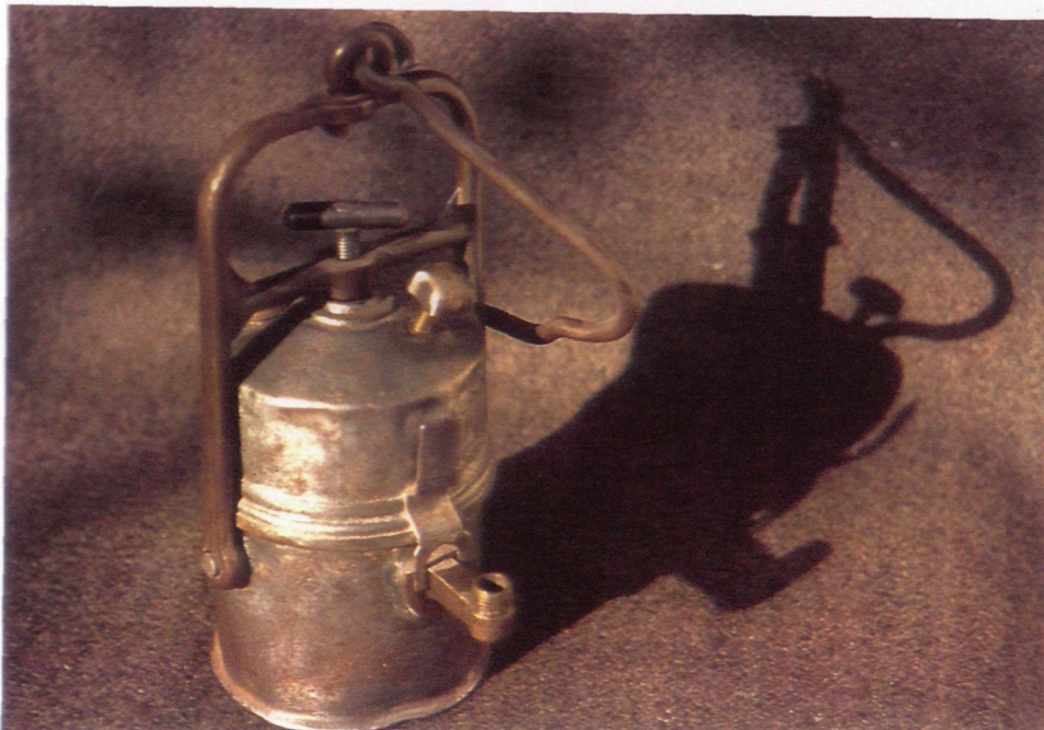
Abb. 5 Karbidlampe mit starrem Doppelbügel. Hersteller: Carl Bleckmann & Co., Salzburg. „BLECO-Lampe“ aus dem ehemaligen Kupfer- bergbau Mitterberg, Mühl- bach am Hochkönig
