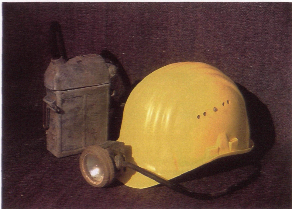
Abb. 8: Akku-Kopflampe mit Plastikhelm in der heute allgemein verwendeten Form Type 14201, Hersteller Friemann & Wolf GmbH, Duisburg
