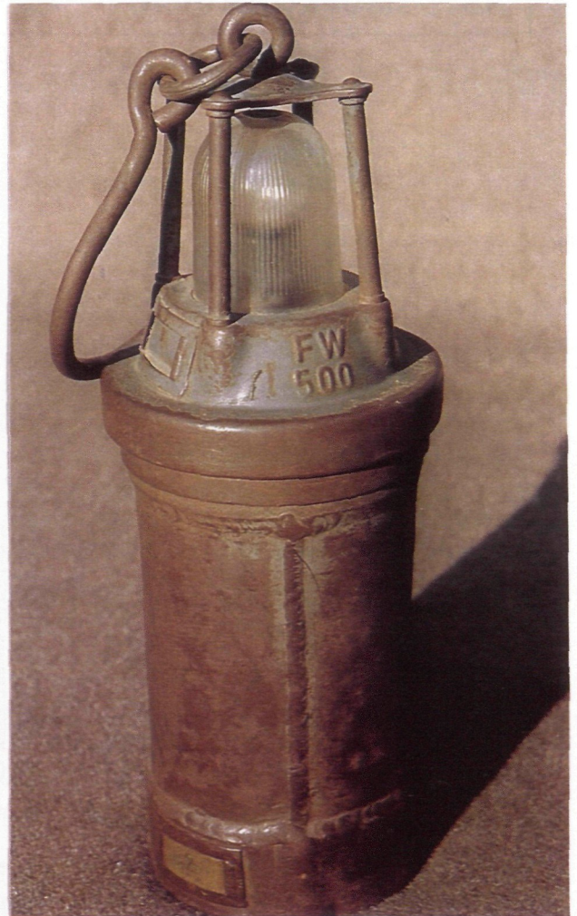
Abb. 7: Panzerlampe Typ FW 500, Hersteller Friemann & Wolf GmbH in Duisburg, aus dem Glanzkohlenbergbau Seegraben bei Leoben
