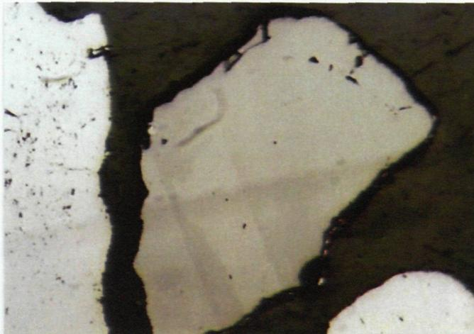
**Abb. 8:** Zinnstein mit sichtbarem Reflexionspleochroismus (RPL) an Zwillingsgrenzen. Kassiteritkorn mit Reinzinnrinde und zwei Ilmenitkörnern. Anschliff, // Nicols, Präparat aus Bachsediment. Durchmesser Zinnstein: 0,5 mm
