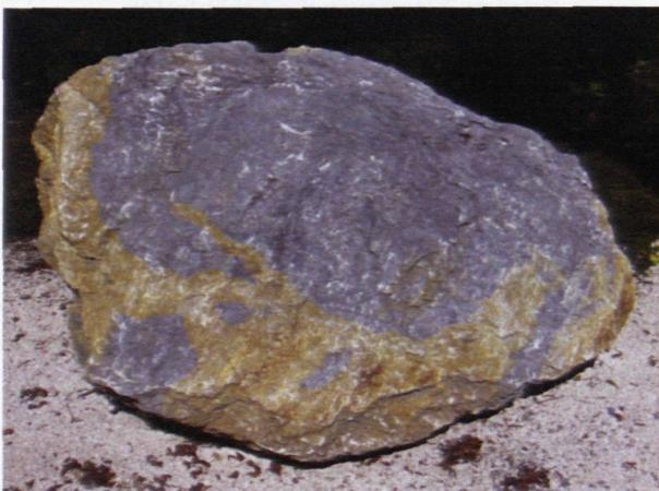
Abb. 7: Der graue Opponitzer Kalk verrät durch seine graue Farbe einen hohen Anteil an Tonmineralen und ist dadurch ein hervorragendes Rohmaterial für die Zementherstellung im Zementwerk Kirchdorf.
