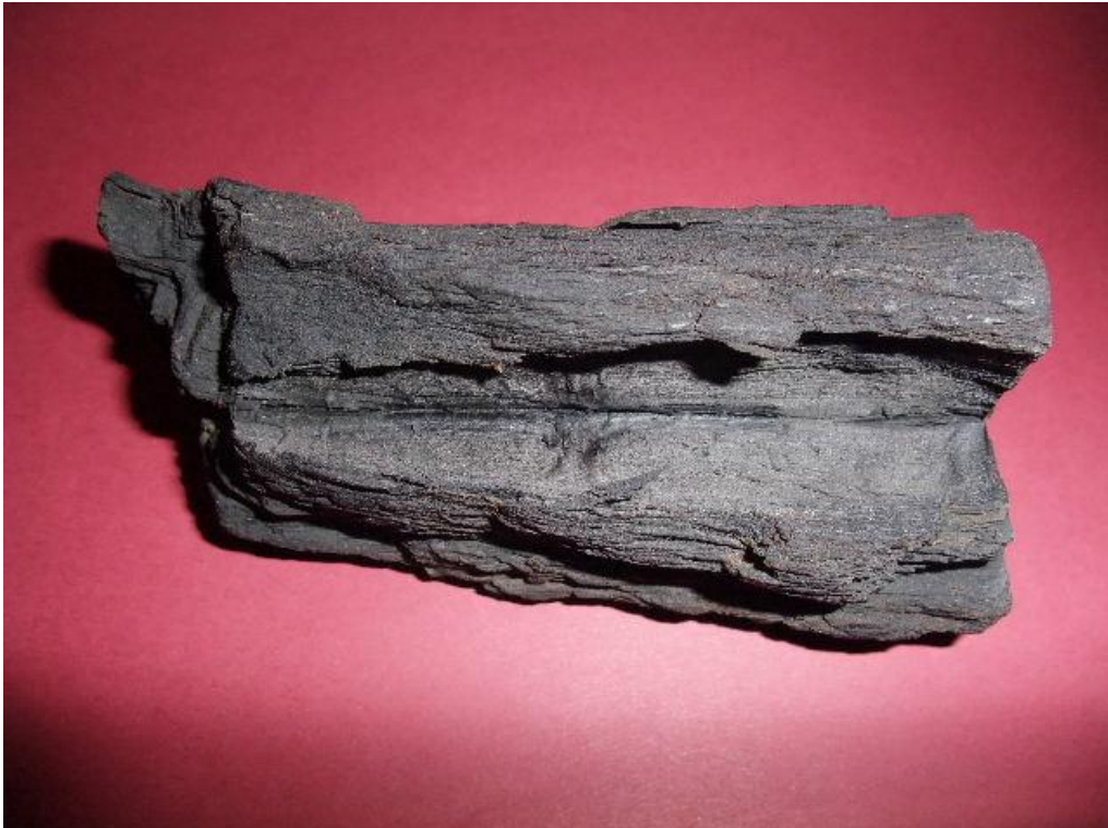
Abb.5: Inkohltes Holz mit Riss, der sich beim Trocknen gebildet hat.
