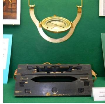
Abb. 16: Hängekompass mit Transportbehälter
