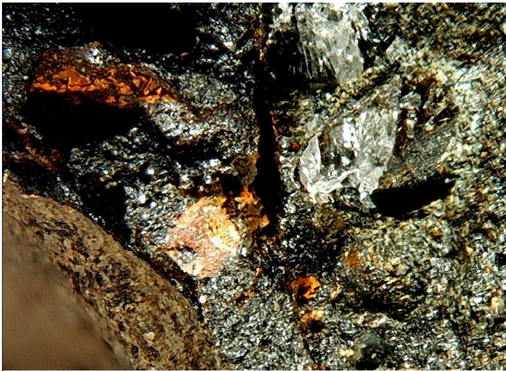
Abb.18: Eine zu den Analogien von Massicotit (gelb) und Lithargit (rot) umgewandelte Bleikugel. Im unteren Bereich ist rudimentäres Blei zu sehen. Durchmesser der Kugel 0,6 mm. Foto P. Arthofer, Steyr
