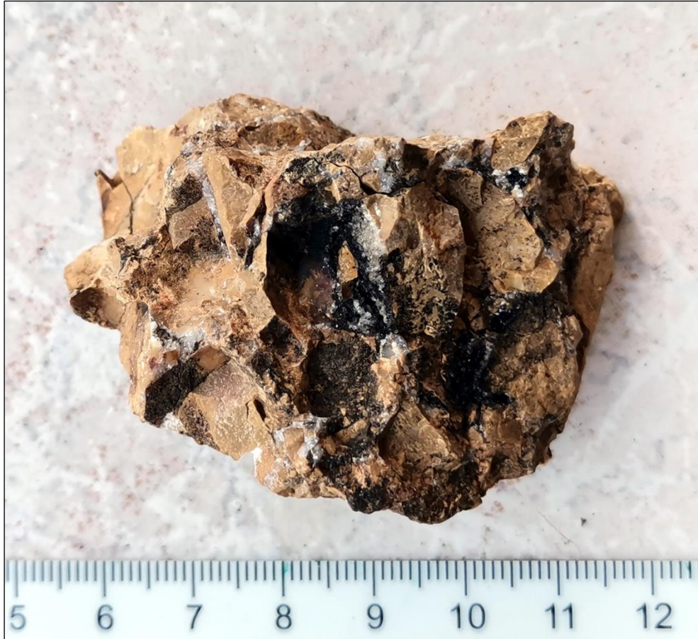
Abb. 31: Asphalt in einer Brekzie aus braunem, bituminösen Kalk mit jungen Kalkspatkluftfüllungen. Obertägiger Fund aus dem Haldenmaterial des Hütterstollens. Sammlung: Verfasser
