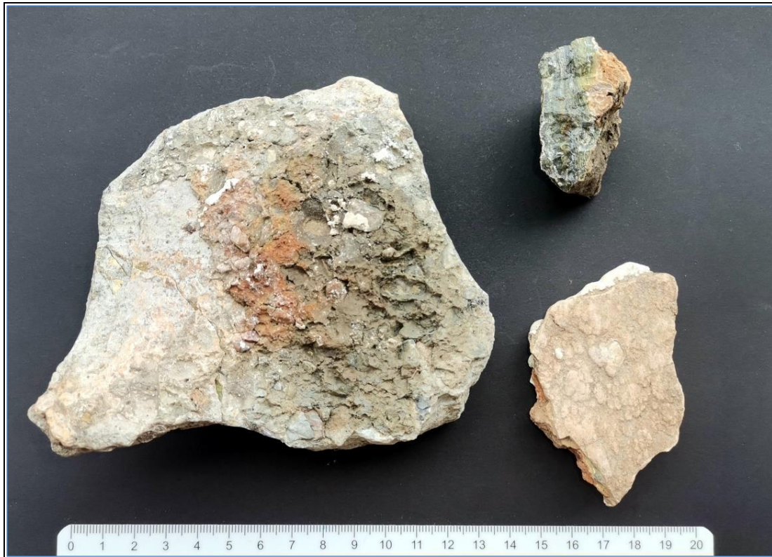
Abb. 49: Abgelassenes Gemenge von Blei und Zink als unerwünschtes Nebenmetall, Schmelzplatz Stambach. Sammlung und Foto: Verfasser
