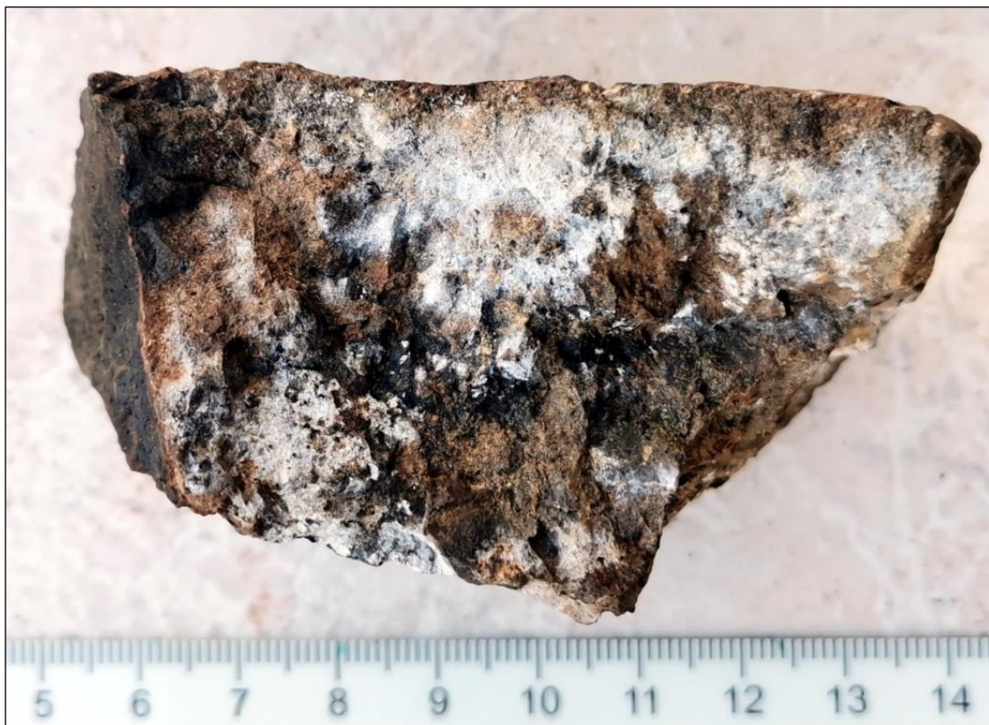
Abb. 26: Hydrozinkit in weißen dünnen Krusten auf sideritischer Erzprobe mit eingesprengter Zinkblende und Bleiglanz. Obertägiger Fund aus dem Haldenmaterial im Eisenarzes. Sammlung: Verfasser
