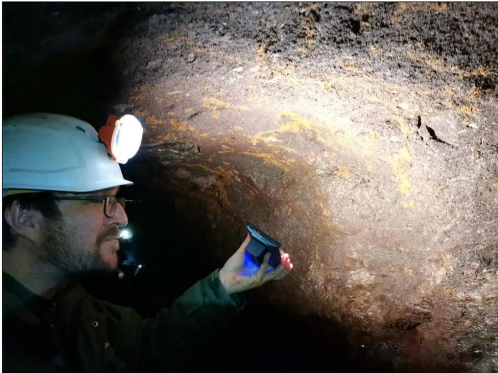
Abb. 32: DI TH. LEITNER bei der Suche nach brauchbaren Beprobungsstellen an den mit dicken Oxidationskrusten überzogenen Wänden der Stampfer Kehr.
