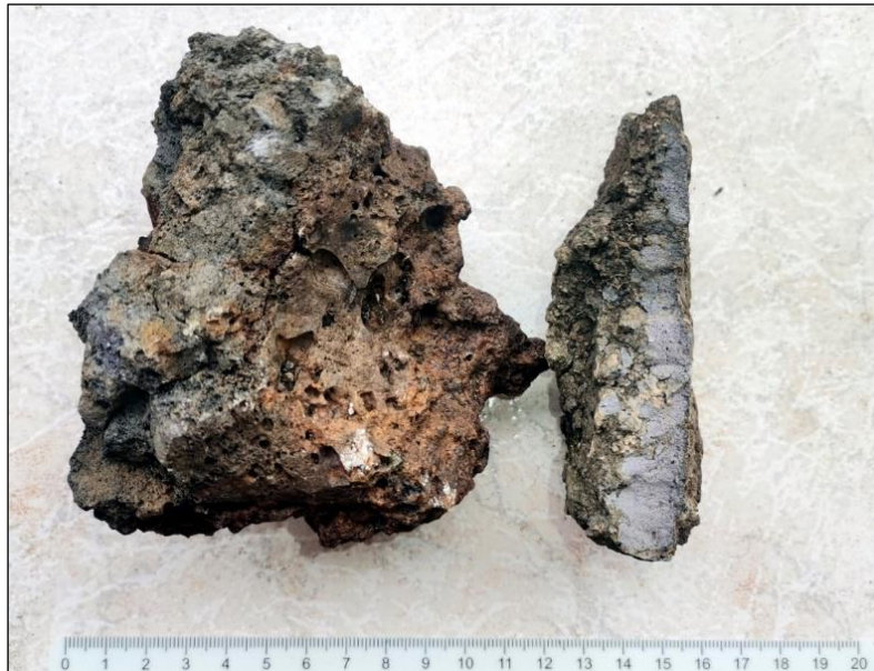
Abb. 47: Glasig-poröses Hüttenprodukt, links brekziös mit Übergang zur heterogenen Schlacke, Schmelzplatz Stambach. Sammlung: Verfasser
