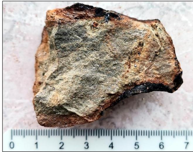
Abb. 33: Vererzter Werfener Schiefer aus der Brekzie II mit Galenit und Siderit aus den Halden der Reinfalzalm. Eisenarz.
