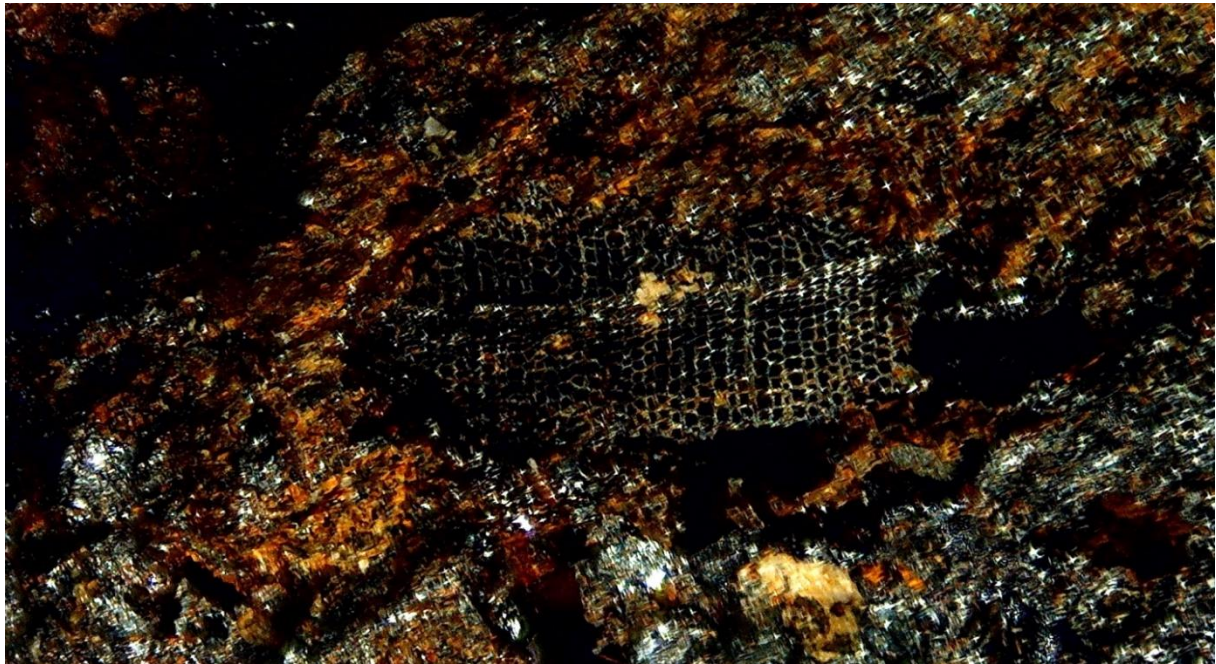
Abb. 40: Holzkohlenrelikt in heterogener Schlacke, deutlich sichtbar die Struktur der Kanäle des Nadelholzes im Querbruch. Sammlung: Verfasser
