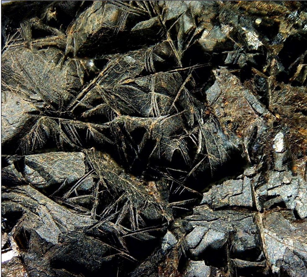
Abb.52: Fayalit-Analogon: In einem Hohlraum finden sich tafelige Kristalle im Spinifex-Habitus und bauen dabei ein Kartenhausgerüst auf. Typisch für schnell abkühlende, niedrigviskose Schmelzen. Schlackenplatz Stambach, Bildbreite 2 Millimeter. Fund und Foto: Verfasser
