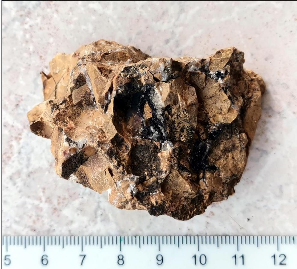
Abb. 31: Asphalt in einer Brekzie aus braunem, bituminösen Kalk mit jungen Kalkspatkluftfüllungen.
