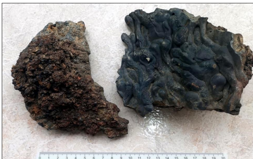
Abb. 45: Laufschlacke Stambach. Rechts die Oberseite mit Fließsträngen, links die Unterseite mit eingebacknem Splitt des Ablaufkanals. Sammlung: Verfasser
