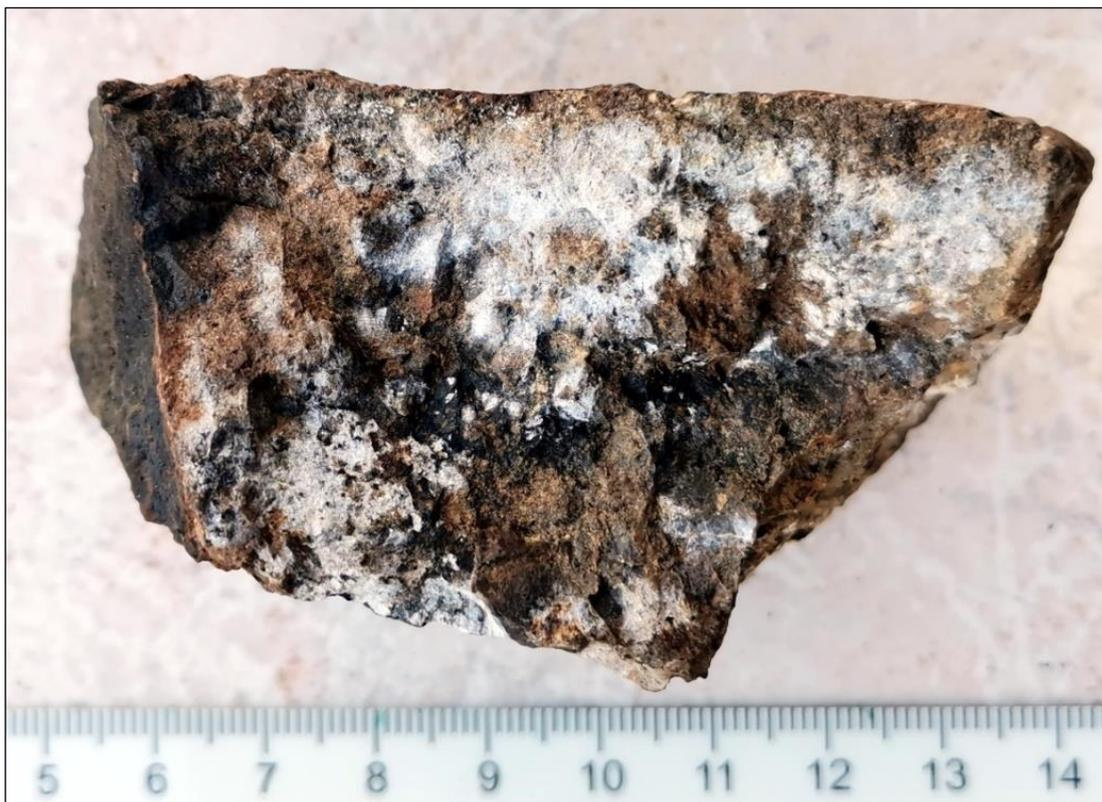
Abb. 26: Hydrozinkit in weißen dünnen Krusten auf sideritischer Erzprobe mit eingesprengter Zinkblende und Bleiglanz.
