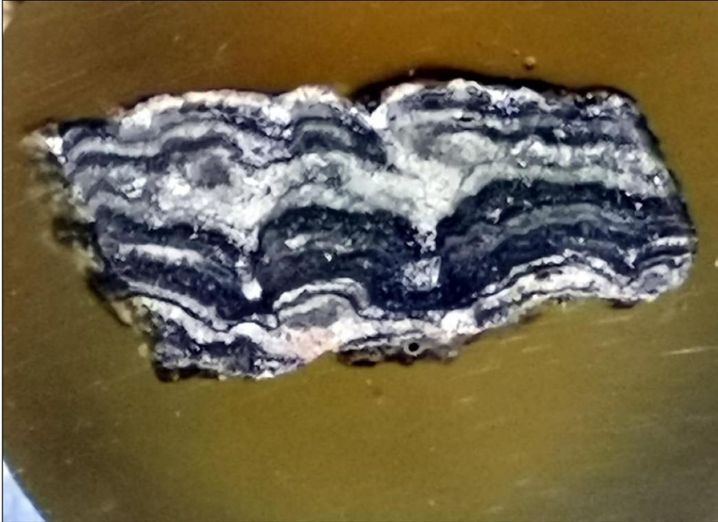
Abb. 53: Präparat vom Querschnitt des Blei-Zinkabfalles des Schmelzplatzes.
