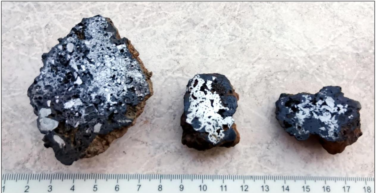
Abb. 50: Metallisches Eisen hell mit schwarzem Wüstit. Proben aus der Zone unterhalb der Luppe.
