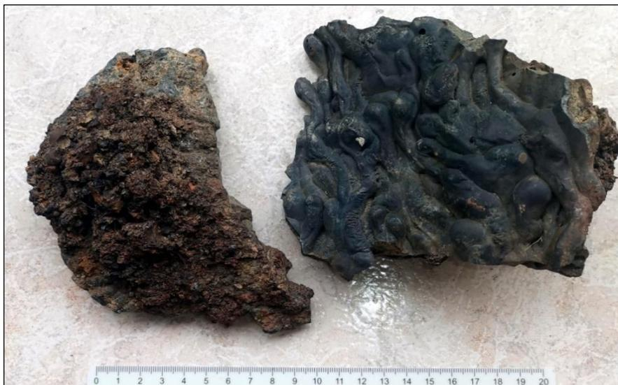
Abb. 45: Laufschlacke Stambach. Rechts die Oberseite mit Fließsträngen, links die Unterseite mit eingebackenen Splitt des Ablaufkanals. Sammlung: Verfasser
