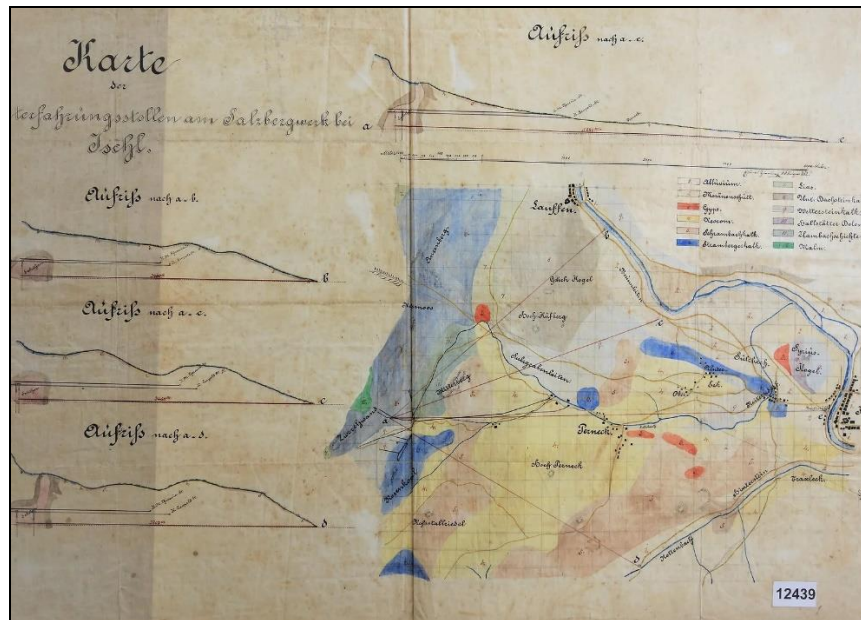
Abb. 7: Karte der Varianten des Projekts zum Bau eines Unterfahrungsstollen des Ischler Salzberges von Eduard Zierler, k. k. Steiger, 1882 mit geologischer Aufnahme. Archiv Salinen Austria.
