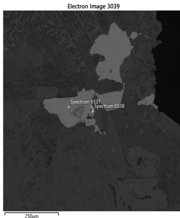
Abb. 17.: Elektronenmikroskopisches Bild eines kleinen Bereiches eines Schliffes eines Metabasalt (Diabas) aus der Bohrung BJ-4. Punkt 6537 markiert Pyrit, beim Messpunkt 6538 handelt es sich um Zinkblende mit Gehalten von Cadmium und Kupfer. Probe aus dem Nachlass E. KIRCHNER, Salzburg. Probenvorbereitung und Sammlung: Verfasser
