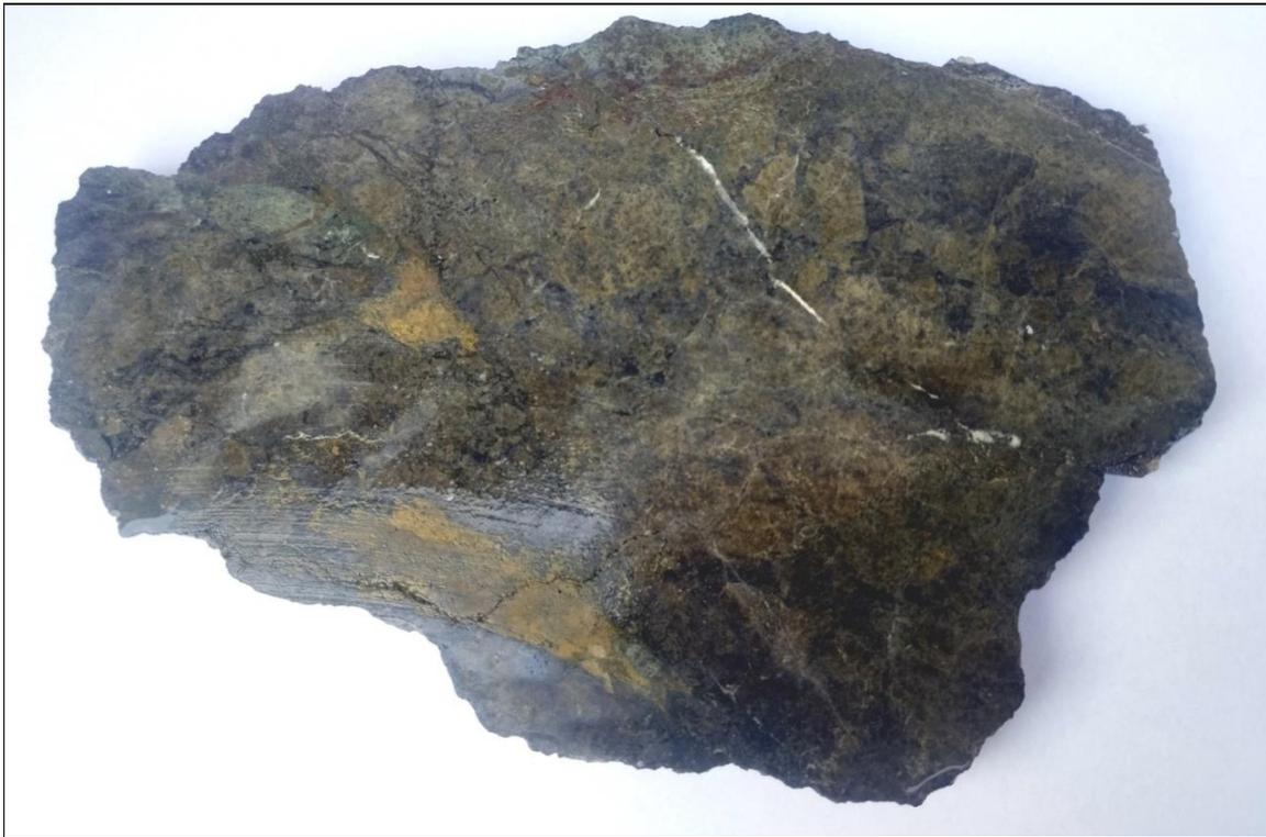
Abb. 13: Scheibe einer Probe des Diabas aus dem Gassnerweg in Bad Ischl. Breite des Stückes 18 Zentimeter .
