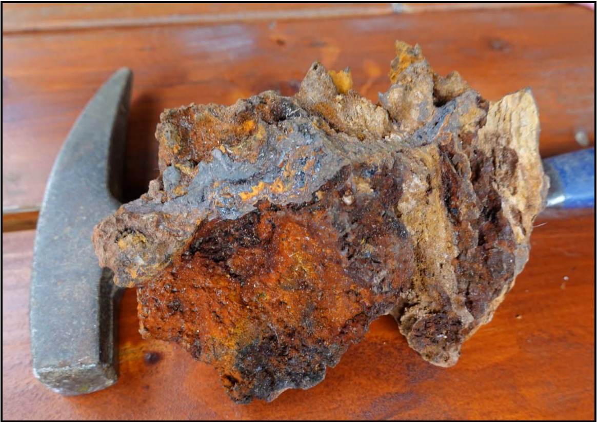
Abb. 11.: Probe eines in Limonit und Goethit umgewandelten Erzstückes aus der Hutzone der Lagerstätte. Foto: A. Kapeller, Steyr
