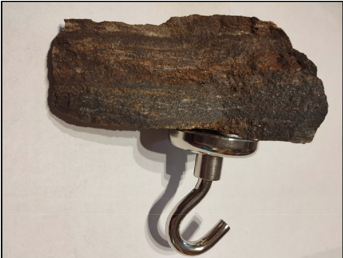
Abb. 12.: Probe eines Magnetitzerstückes mit anhaftendem Magneten, Breite der Probe neun Zentimeter. Foto: A. Kapeller, Steyr
