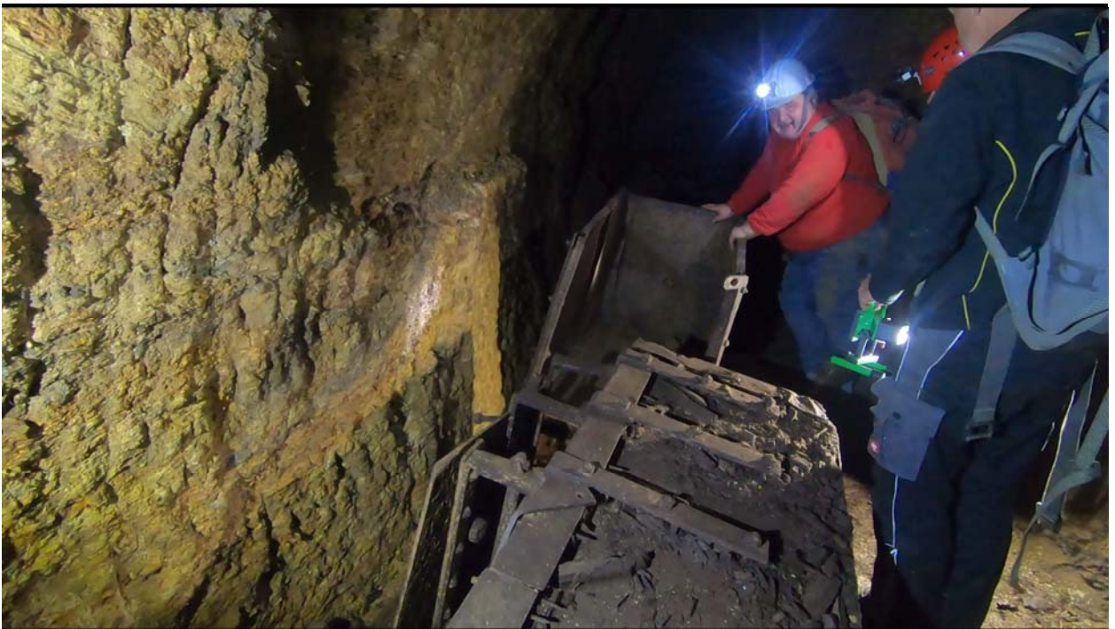
Abb. 8.: Gekippte Hunte, am Ulm finden sich lagenförmige, oberflächlich oxidierte Magnetiterze. Foto: D. Pongratz, Wolfsberg
