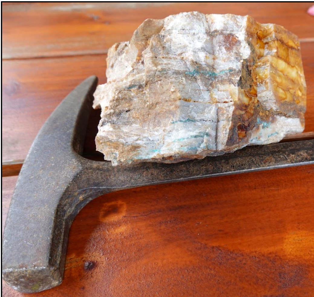
Abb. 10.: Probe eines Quarzganges mit Kupfervererzung und Malachit. Foto: A. Kapeller, Steyr
