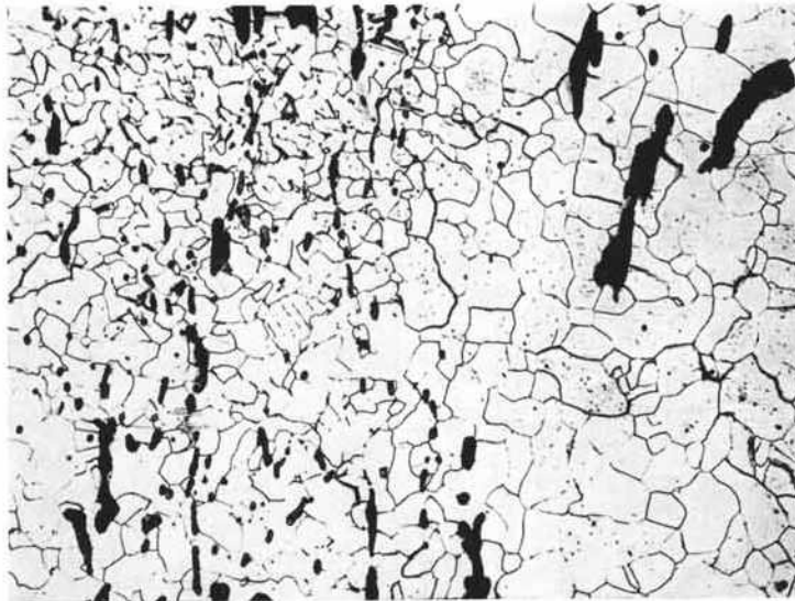
3 Mikrogefüge (Ferrit, zeilenförmige Schlackeneinschlüsse)
