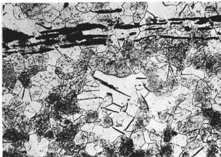
4 Mikrogefüge (wie oben, jedoch Zwillingsbildung im Ferrit durch schlagartige Kaltverformung)
