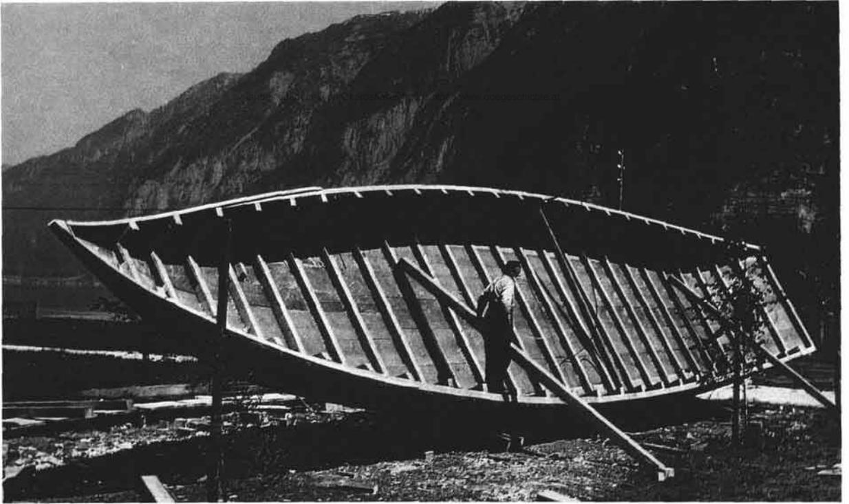
Abb. 8 Obwohl der Schiffsbauer über keine Zeichnung verfügt und jeder Mutzen entsprechend dem vorhandenen Bauholz geringe Maßabweichungen hat, zeigt dieses Bild die harmonische Form des Schiffkörpers. Deutlich die Schiftung des rechten (oberen) Seim.
