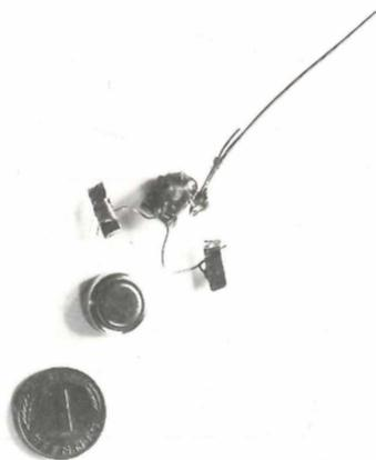
Abb. 1 Sender mit Lötfläden und Antenne, daneben Batterie. – Vor dem Zusammenbau
