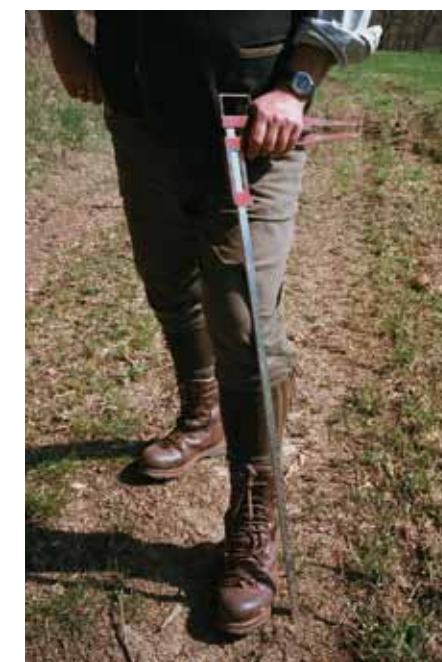
Bei 85 cm endet die „Messkluppe“ zum Erfassen eines Stammdurchmessers. Zu wenig für Klitschkos Bäume.
