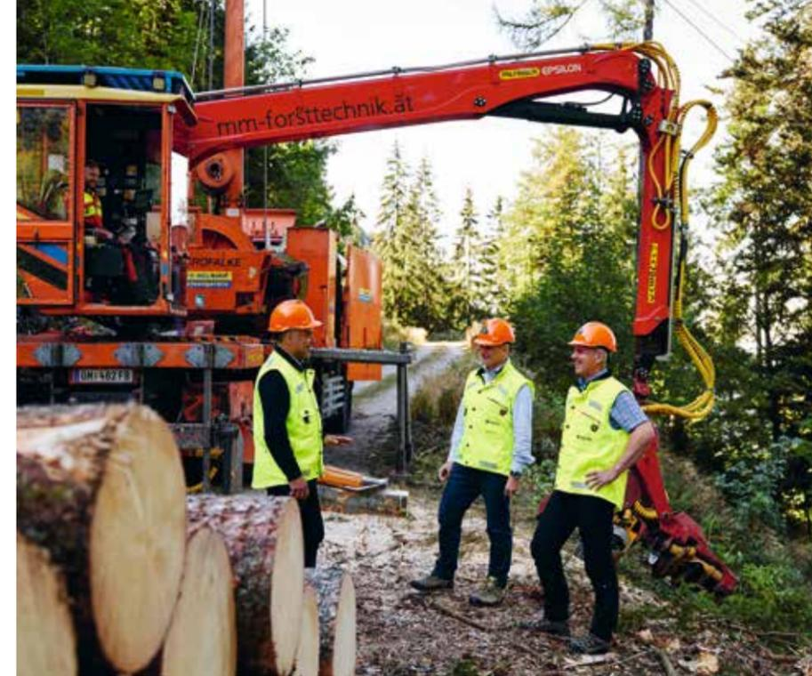
In steilen Lagen wird das Holz mit einem Seilkran geerntet. Das schont den Boden und den jüngeren Baumbestand.
