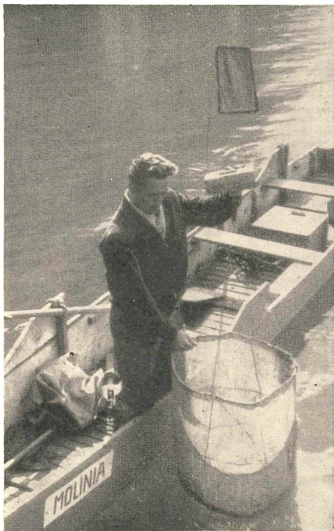
Abb. 2: Aussetzen eines Schwimmkorbes zur Strömungsmessung
