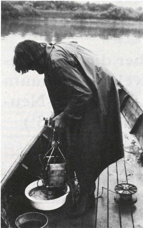
Abbildung 1: Entnahme von Schlammproben mit Hilfe eines Bodengreifers.
