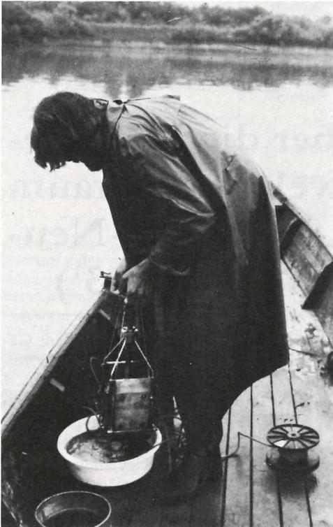
Abbildung 1: **Entnahme von Schlammproben mit Hilfe eines Bodengreifers.**
