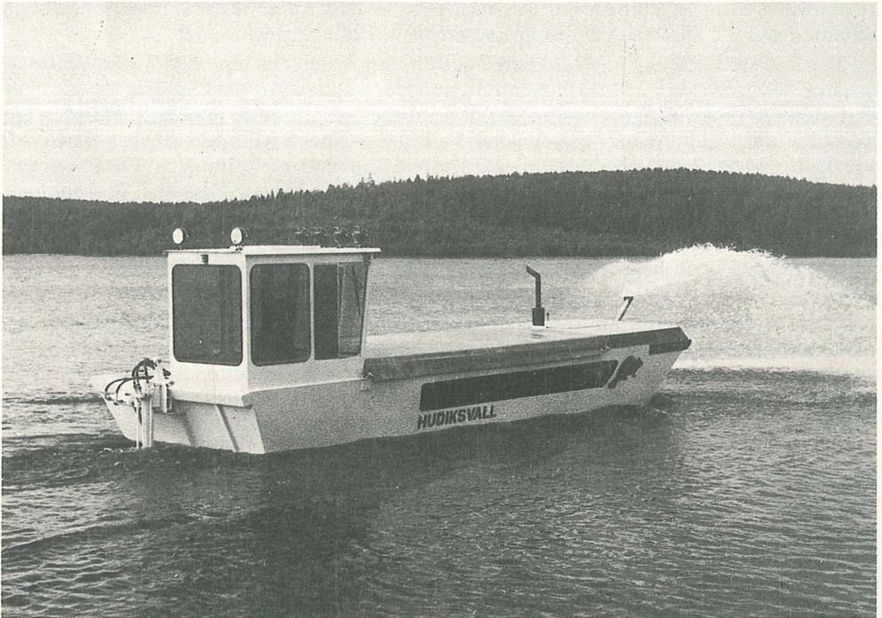
Bekalkungsboot Imek 5000 mit neuartigem Austragverfahren: Kalk und angesaugtes Umgebungswasser werden als Gemenge über die Gewässeroberfläche verspritzt. Arbeitszyklus inklusive Befüllen für eine 6-Tonnen-Ladung: 15 Minuten. (Foto und Info: Idémekaniska System AB)
