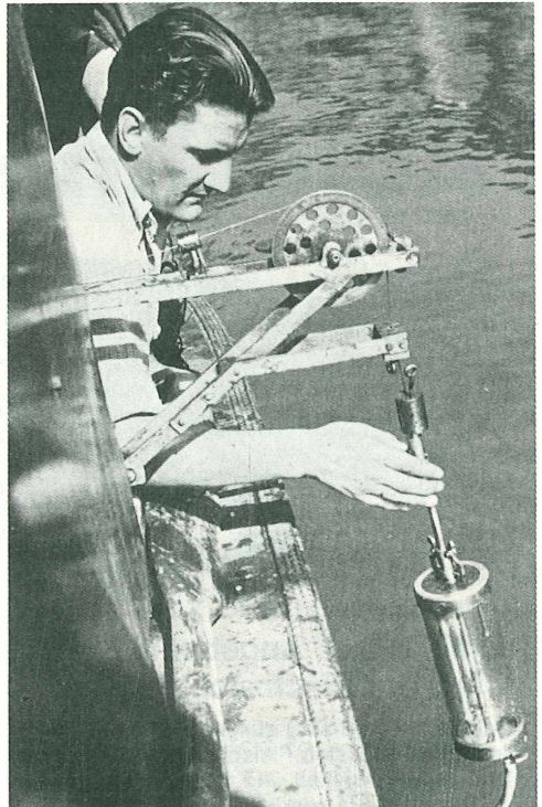
Seemessungen am Traunsee (im Bild R. Kreuzer, 1952). Enmal pro Monat werden seit 1930 Proben aus allen Tiefen des Sees entnommen, auf \text{Cl}^- , \text{O}_2 und Säurebindungsvermögen untersucht.
