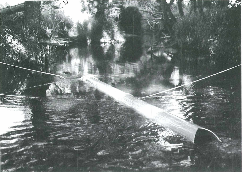
Abb. 2: Lage der Benthos-Rohre am Gleit- (G) und Prallhang (P) sowie im Hauptstrombereich (H) in der Felda
