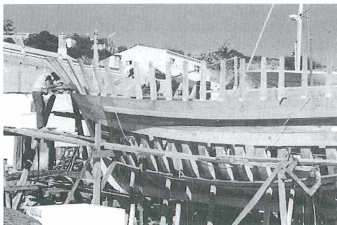
Die Kutter in Portugal werden noch aus Holz wie zu Urzeiten gezimmert. Mit einem solchen Schiff wird am Cabo in Sagres den Haien nachgespürt
