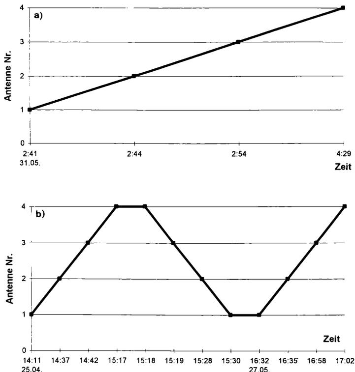
**Abb. 3:** Vergleichende Bewegungsmuster im Beckenpaß in Scheuerfeld: a) Döbel (Länge 34,5 cm; ID-Code 001BBB8E3), zügig die Fischaufstiegsanlage durchschwimmend; b) Bachforelle (Länge 27,0 cm, ID-Code 00010D2AF), die zwar zunächst bis Antenne 4 aufschwamm, dann jedoch wieder ins Unterwasser umkehrte und erst am darauffolgenden Tag den Fischpaß erfolgreich ins Oberwasser parierte.
