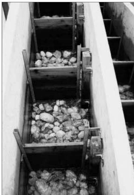
Foto 5: Becken mit eingebrachtem Sohlsubstrat.
