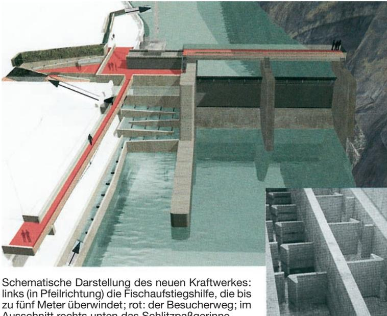
Schematische Darstellung des neuen Kraftwerkes: links (in Pfeilrichtung) die Fischaufstiegshilfe, die bis zu fünf Meter überwindet; rot: der Besucherweg; im Ausschnitt rechts unten das Schlitzpaßgerinne
