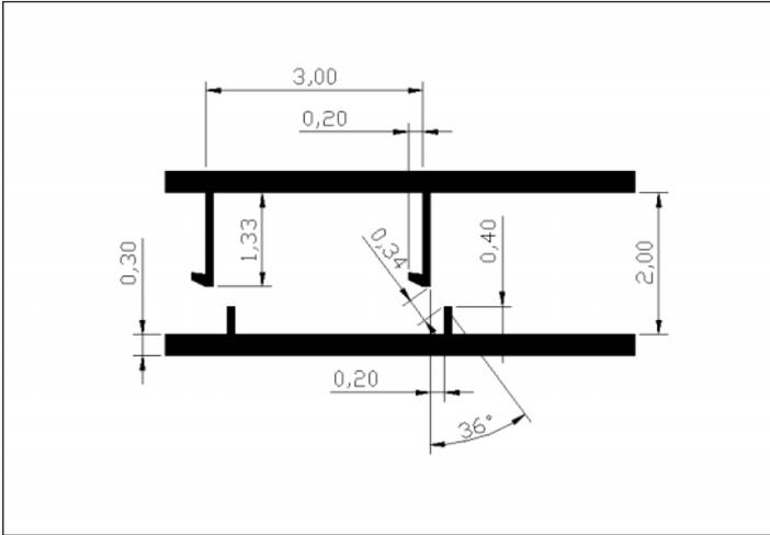
**Abb. 1:** Dimensionierung des Schlitzpasses an der Fischaufstiegshilfe Murau
