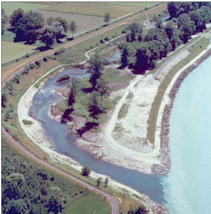
Abb. 18: Mündung des Liechtensteiner Binnenkanals nach der später vorgenommenen Sanierung in Form eines natürlichen Fließgewässers (Bild: P. Rey)
